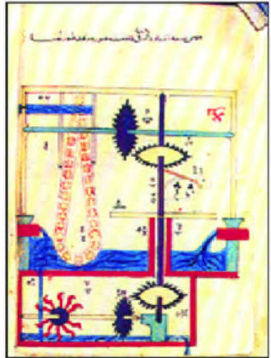
( ١٣١ ) تقنية أخرى للجيزري لرفع الماء بقوة الماء .
